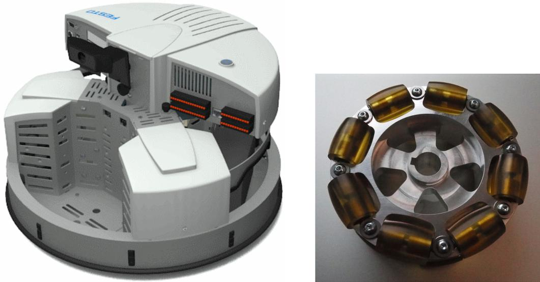
Abbildung 2.37: Robotino 3 Plattform (links) und neu entwickeltes Omnirad (rechts)
